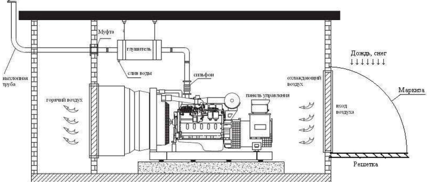
Электростанция должна располагаться в помещении с хорошей вентиляцией, при этом воздух из помещения просасывается сквозь радиатор вентилятором и выбрасывается наружу через выходной проем. Такая система охлаждения и вентиляции должна быть организована следующим образом :
