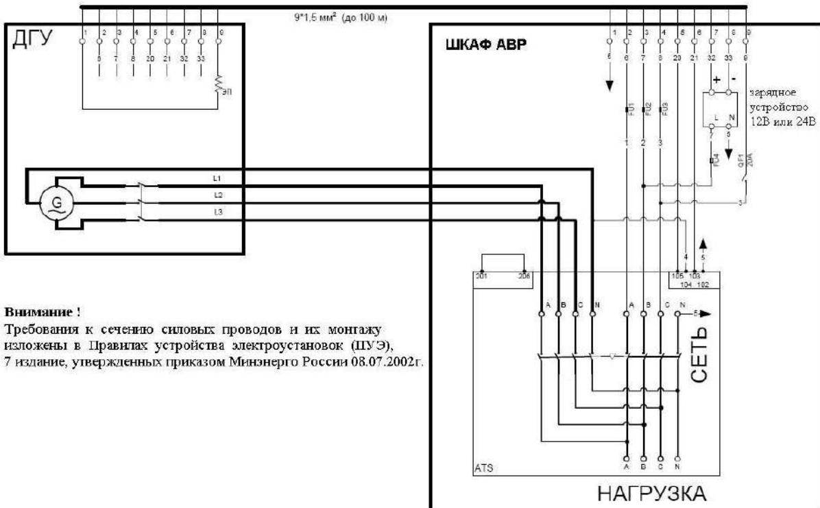
Соединения кабеля управления между шкафом управления ДГУ и шкафом ATS выполняйте между установленными в них клеммными колодками с соответствующей нумерацией.
