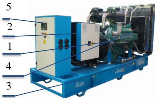
**1)Дизельный двигатель** с непосредственным впрыском топлива и водовоздушным охлаждением, с турбокомпрессором и регулятором частоты вращения; Установленным навесным оборудованием и оборудован системами обеспечения.
