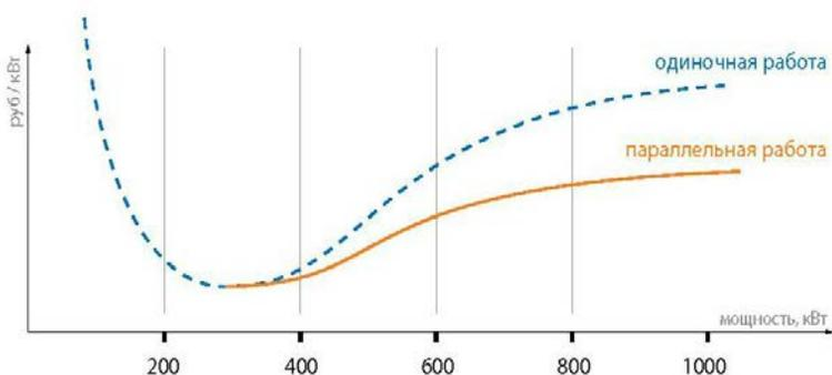
Важным отличием эксплуатации группы электростанций от одного агрегата является заложенная в систему возможность работы на низких нагрузках. Как следствие, большой рабочий диапазон и значительная экономия средств.
